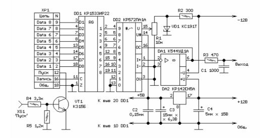
Способ получения аналогового сигнала произвольной формы с помощью компьютера аналогичен описанному в [2]. На рисунке приведена принципиальная схема предлагаемого варианта устройства. Цифровой сигнал берется с параллельного порта компьютера через разъем XP1 и преобразуется в аналоговый с помощью цифро-аналогового преобразователя (ЦАП) на микросхемах DD2 с
