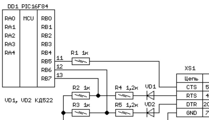
Для преобразования уровней RS-232 в ТТЛ используются резистивные делители R2R4 и R3R5. Диоды VD1 и VD2 необходимы для того, чтобы не пропускать отрицательное напряжение, соответствующее логическому нулю. Выходной ТТЛ сигнал микроконтроллера в преобразовании не нуждается и может быть подключен к входным линиям COM порта непосредственно. Резистор R1 служит для ограничения тока с выхода микроконтроллера при возможном случайном коротком замыкании.
